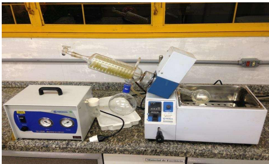
Figura 17 – Processo de Rotoevaporação.
