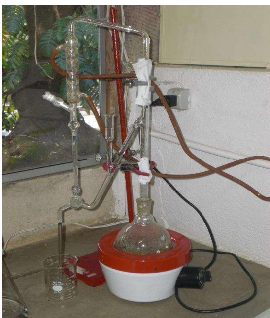
Figura 14 – Processo de Hidrodestilação (AZAMBUJA, 2013).
