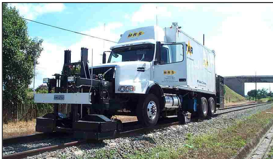
FIG. 4.1: Veículo de Avaliação da Via FONTE: MRS (2007, b)
