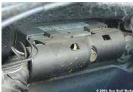
O conector na unidade de controle do motor possui mais de 100 fios
