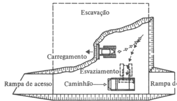
Figura 2.6 - Manobras da pá carregadeira
