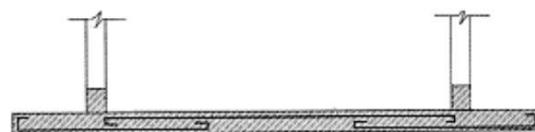
Figura 5.11 - Disposição da armadura no radier
