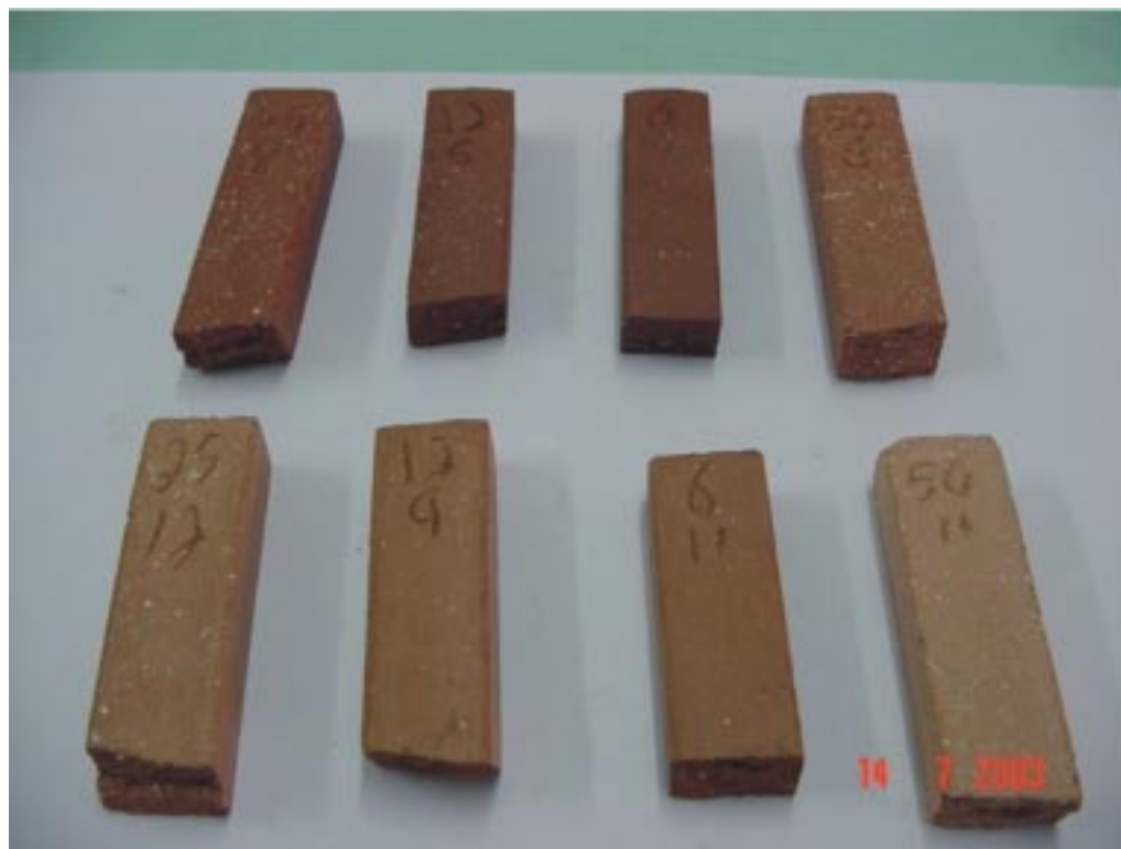
Foto 5 – Corpos de prova da mistura argila-filito. Os números da parte superior definem os percentuais de filito presente na mistura.
