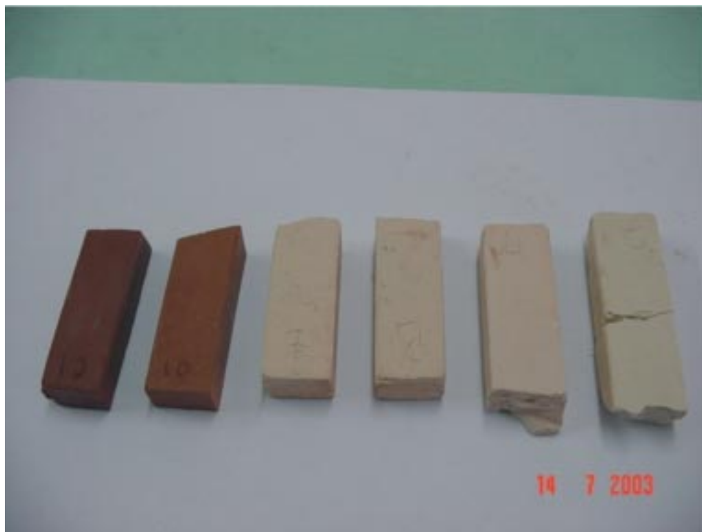
Foto 4 – Corpos de prova constituídos de argila (N os 10 e 12) e de filito (N os 7 e 8)
