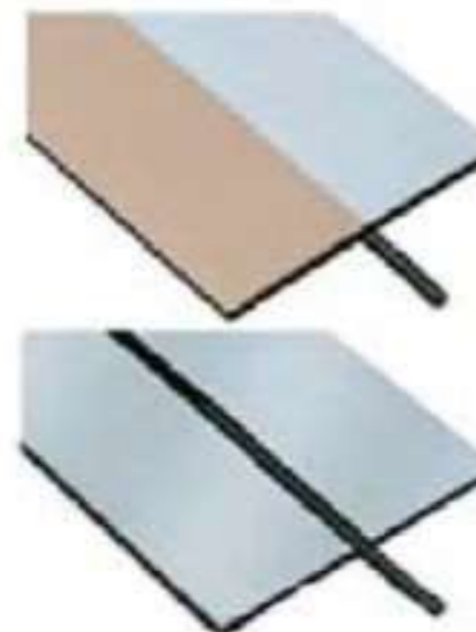
Painéis unidos por soldagem do núcleo de polietileno
