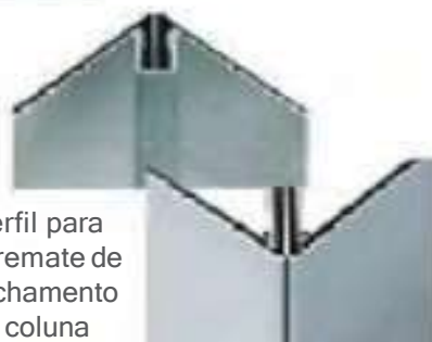
Junção de painéis de coluna por rebite
