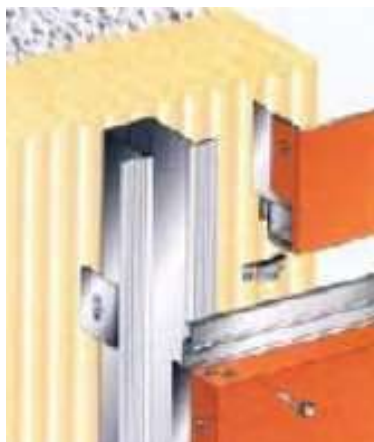
Secção horizontal Parafusada a perfil Omega
