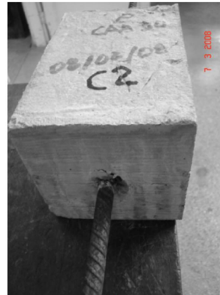
Ruptura por deslizamento da barra
