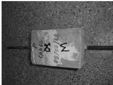
Ruptura por deslizamento da barra
