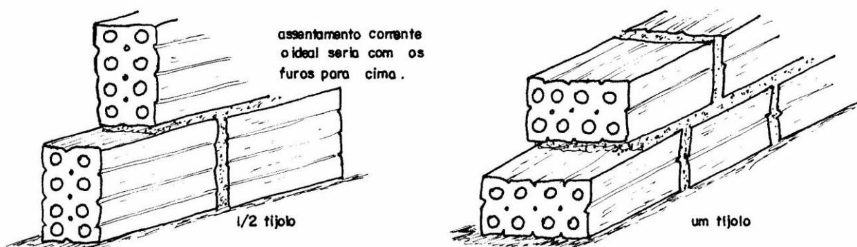
Figura 4.27 - Execução de alvenaria utilizando tijolos furados
