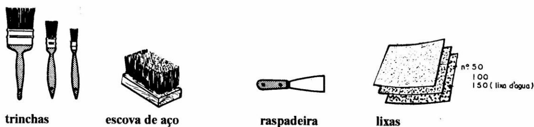
Figura 10.2 - Materiais utilizados no preparo e aplicação das pinturas em metais
