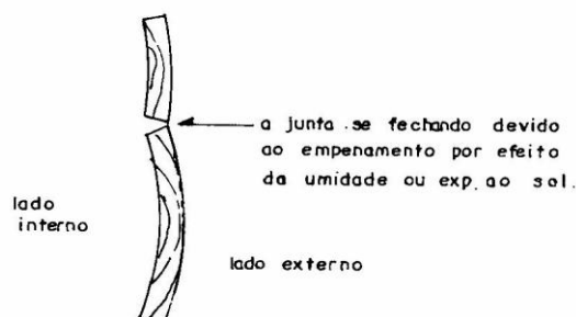
Figura 11.17 - Detalhe da fôrma utilizando tábuas
