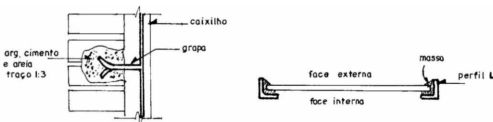
Figura 7.17 - Fixação dos caixilhos de ferro na alvenaria e dos vidros nos caixilhos
