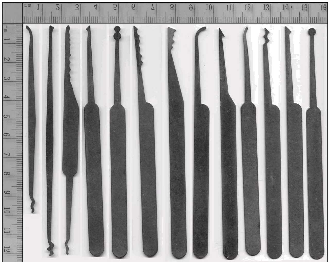
Modelos de hastes (picks) de metal usados para abrir/arrombar fechaduras
