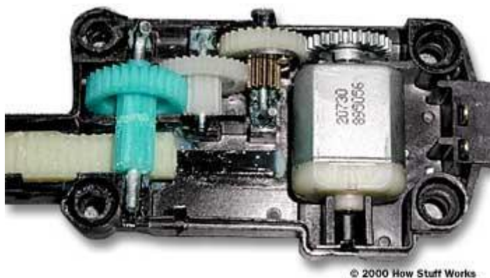
Interior do atuador das travas elétricas das portas
