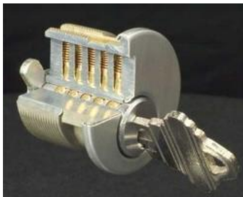
Cilindro partido lateralmente, mostrando o mecanismo de pinos internos
