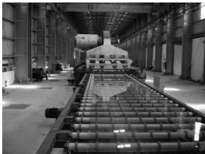
Figura 5.26 – Linha de fabricação de vidros planos (PV PRODUCTION, 2013)
