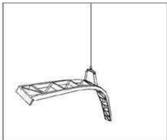
Figura 6.10 – Treliça dobrada por flambagem lateral
