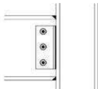
Figura 5.9 – Solda das mesas e parafusos na alma
