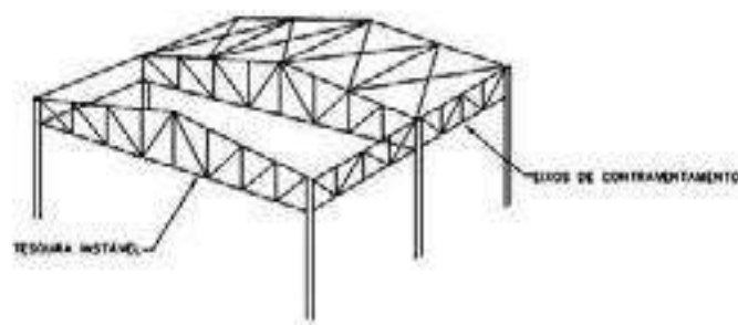
Figura 6.9 – Estrutura de Galpão em aço
