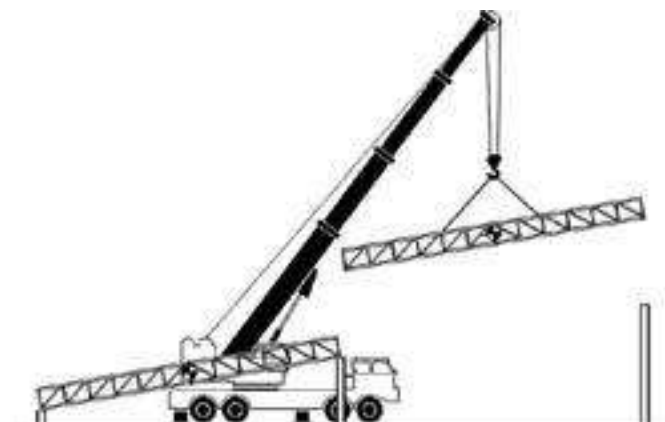
Figura 4.13 – Montagem de estrutura inclinada
