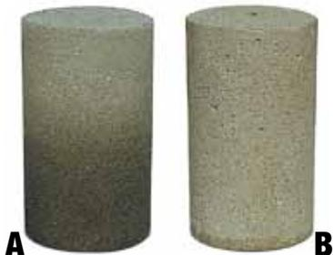
No prisma **A**, sem aditivo, a umidade atinge toda a peça.
