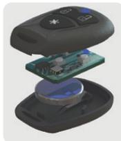
Abra a caixa plástica com cuidado, pelas laterais. Substitua a bateria, observando a polaridade “+” e “-”.
