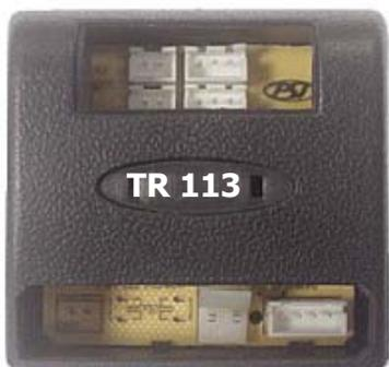
Por trabalharem com reversão de polaridade estas travas necessitam de centralina externa para acionar os demais motores.
