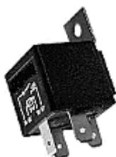
O mesmo ocorre com os terminais "85 e 86", onde muitos instaladores adotam um como *positivo* e o outro como *negativo*. Estes dois terminais pertencem a bobina do relé (eletroímã), não tendo desta forma nenhuma determinação de polaridade. Sendo assim, não iremos nos preocupar quanto aos detalhes de polaridade.
