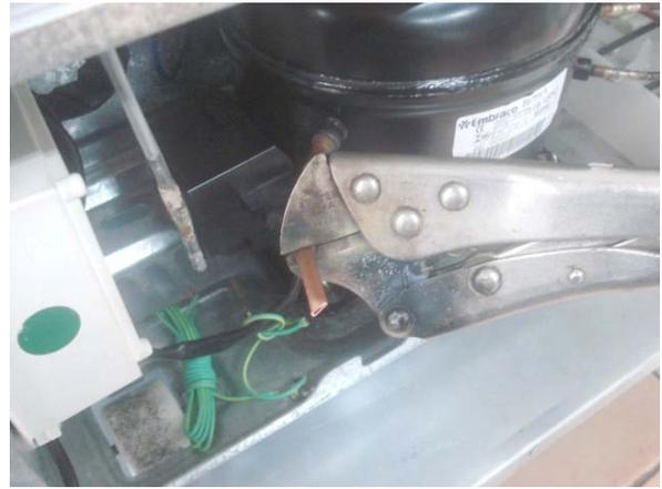
8.1.23 Solde a extremidade do tubo de processo com vareta Silfoscooper e reforce com solda o ponto onde foi estrangulado.
