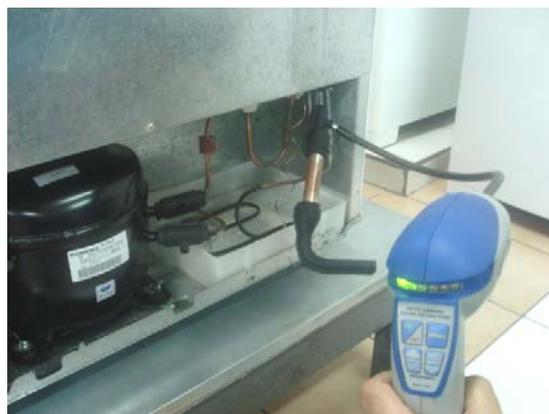
9.4 Ligue o compressor e repita o item 9.3 para identificar vazamentos na linha de alta pressão.
