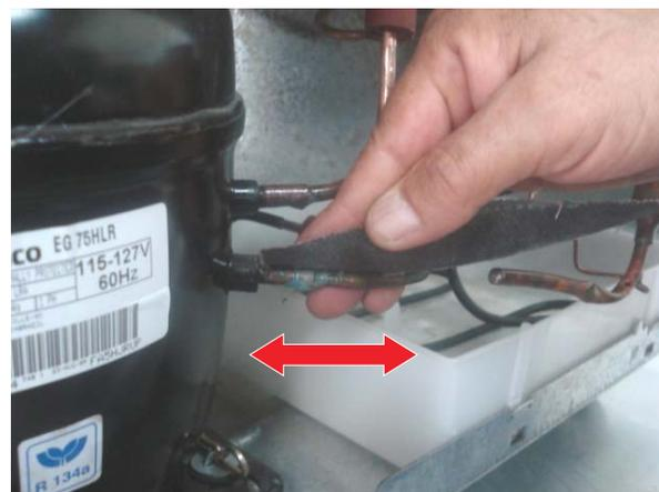
5.2 Proceda a limpeza externa do tubo de saída do condensador, esta deve ser feita bem próximo ao filtro secador.
