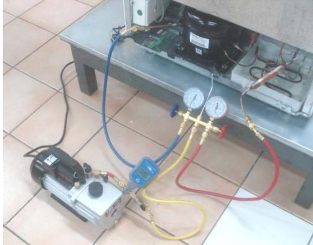
7.5 Ligue a bomba de vácuo e vacuômetro digital.
