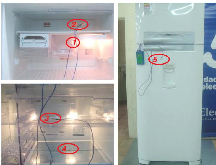
PONTOS DE MEDIÇÃO NOS REFRIGERADORES FROST FREE
