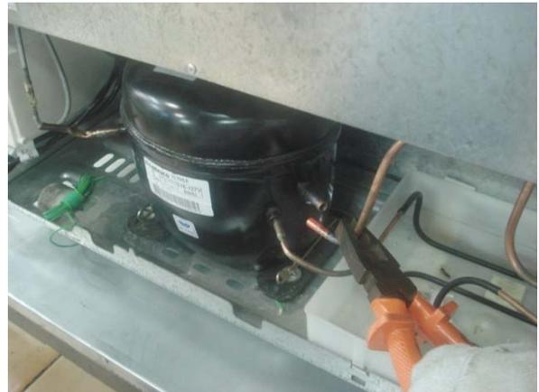
**5.10.2** Dessorde o tubo de descarga do compressor (linha de alta pressão).
