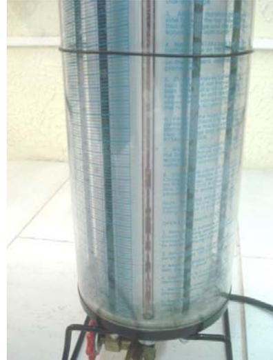
8.2.5 Encha o cilindro sem ultrapassar o limite máximo indicado no visor transparente.
