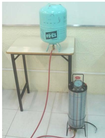
8.2.3 Abra totalmente o registro inferior do cilindro dosador e do cilindro de gás refrigerante, que deve ser mantido de cabeça para baixo, caso não tenha pescador. Para facilitar, coloque o cilindro de gás no nível acima do cilindro dosador.
