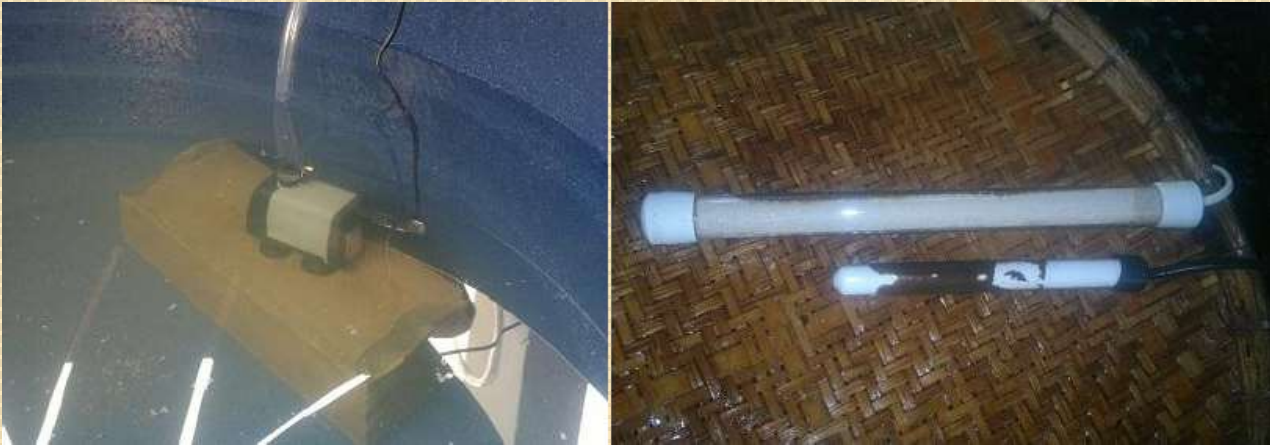
Figura 9 Motor de sucção de água e aquecedores para o tanque de peixes (150 e 100 W).
