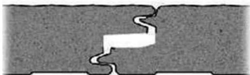
Figura 3.7 – Detalhe de encaixe de topo entre dois painéis adjacentes. (DÂNICA, 2013a).
