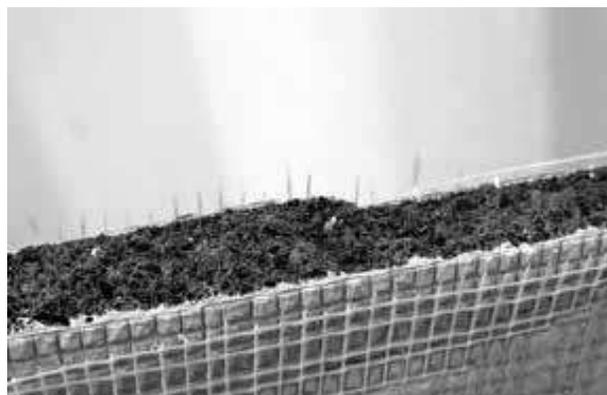
Figura 2.8 – Detalhe da placa cimentícia fabricada com agregado leve e malhas de fibra de vidro nas duas faces externas. (Acervo Inovatec Consultores)
