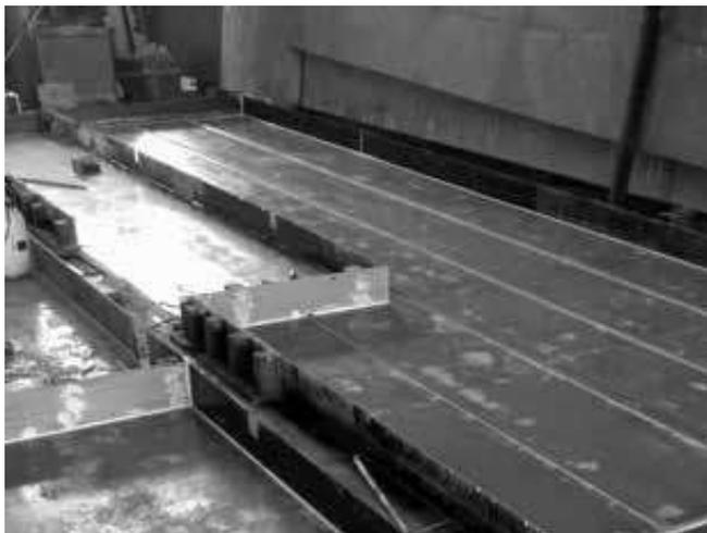
Figura 4.6 – Fôrma de aço customizada para atender projeto específico de painéis de fachada. (HISADA et al., 2013)
