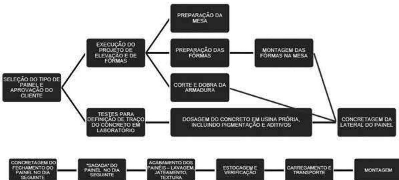
Figura 4.5 – Etapas do processo de fabricação dos painéis até sua instalação. (HISADA et al., 2013)
