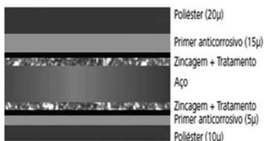
Figura 3.10 – Composição do aço pré-pintado, considerando a exposição a ambientes moderadamente agressivos (a face superior representa a face externa). O revestimento em zinco ou em liga de alumínio-zinco é opcional (PERFILOR, 2007)
